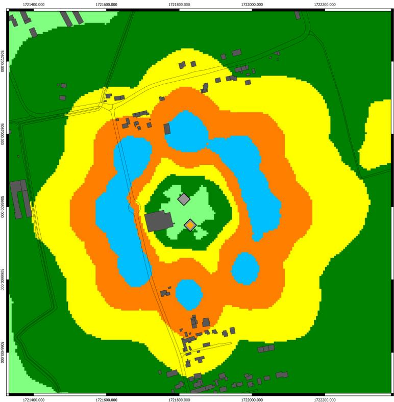
Campo elettromagnetico (V/m) calcolato alla quota di 10,12 m sul livello del terreno
