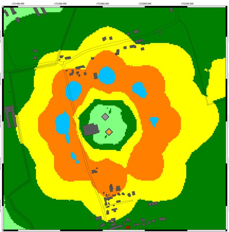
Campo elettromagnetico (V/m) calcolato alla quota di 8,12 m sul livello del terreno
